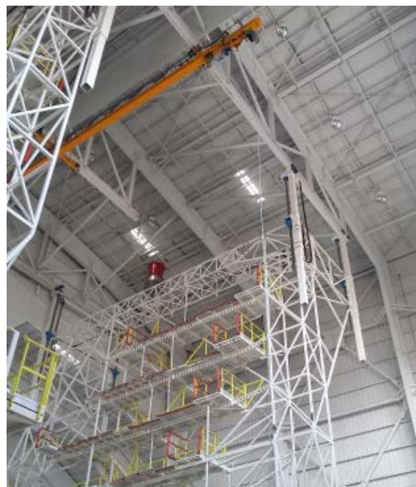
**1** На одном китайском машиностроительном предприятии применяются двухбалочные мостовые краны с канатными талями AS 7. Многие краны работают с двумя грузоподъемными механизмами: более крупная таль служит главным, а более быстрая, меньшая – вспомогательным подъемным механизмом.
